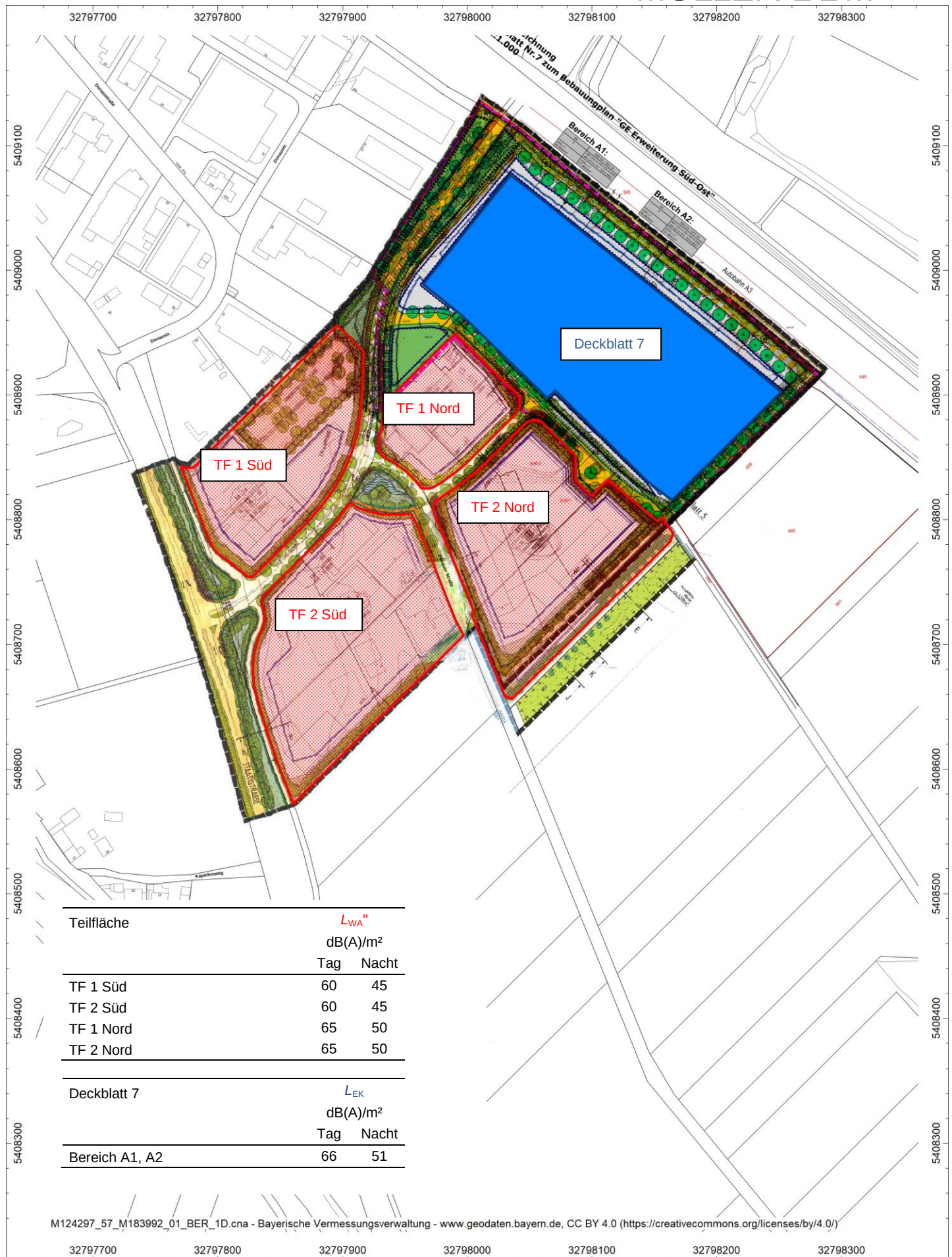
Abbildung A 6. Vorbelastung Bebauungsplan "GE Erweiterung Süd-Ost".
